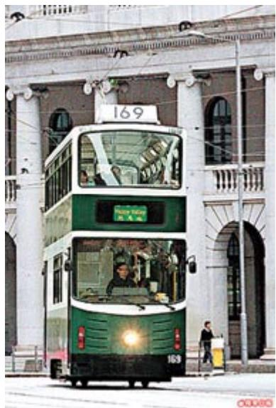
■九倉時期的新電車：車頭車尾的窗是封閉的，被批評空氣不流通。
